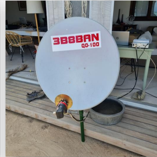
85cm Spiegel mit ca. 15W Ausgangsleistung
